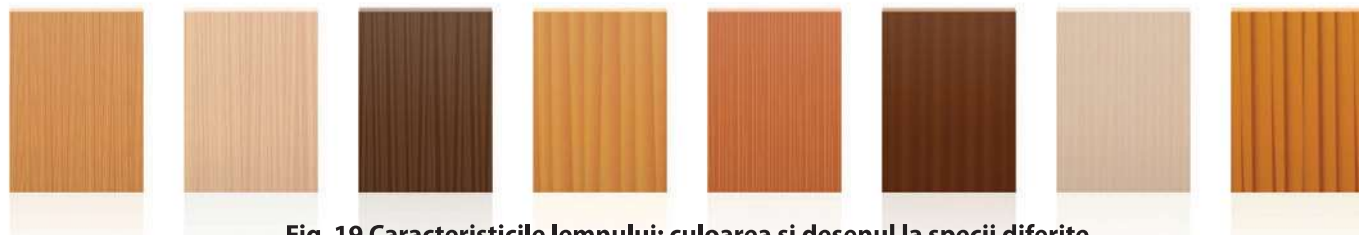
Fig. 19 Caracteristicile lemnului: culoarea și desenul la specii diferite
